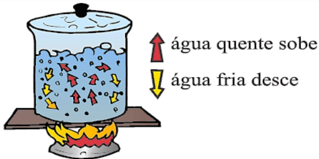
Na **convecção térmica**, as partes diferentemente aquecidas de um fluido movimentam-se no seu interior devido às diferenças de densidades das porções quente e fria do fluido.
